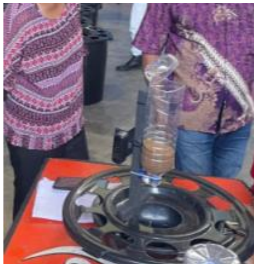
Gambar 2. Implementasi alat pemberi pakan ikan lele otomatis pada sistem budikdamber
