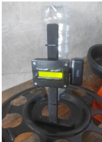
Gambar 1. Alat Pakan Ikan Lele Otomatis Berbasis ESP32
